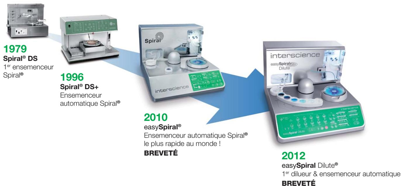
interscience innove encore et vous présente easySpiral Dilute® : un **dilueur & ensemenceur automatique** permettant de faire des dilutions en série jusqu'à **5 dilutions au 1/10<sup>e</sup>** et d'ensemencer jusqu'à **6 log. de dilution** sur une boîte. **Résultat : pour un échantillon contenant de 30 à 1 x 10<sup>12</sup> bactéries, vous ne faites plus de dilutions manuelles et l'ensemencement est automatique !**
